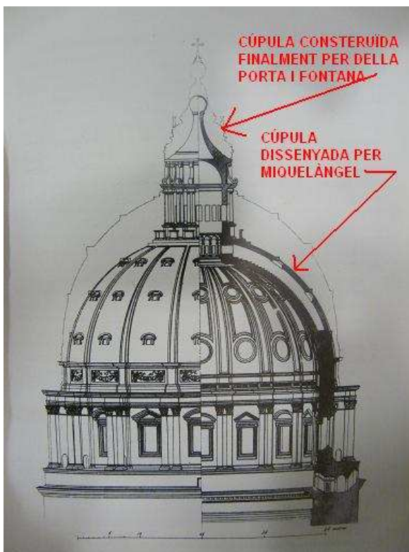
Foto 21. Comparança de perfils entre les cúpules de Miquelàngel i la construïda finalment per della Porta i Fontana entre 1588 i 1593. Devers vint-i-cinc anys després de la mort d'en Miquelàngel Buonarrotti.
